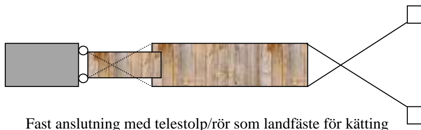
Gjutet landfäste med ingjutna öglor för landkätting
